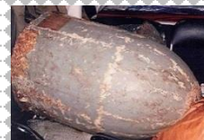
零戦の燃料用タンクに燃料漏れ防止のためセラックは塗られていました。
